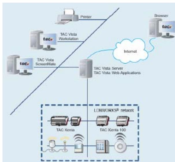
Sistema di supervisione e gestione per edifici che permette il monitoraggio, il controllo e la gestione degli impianti di illuminazione, riscaldamento, ventilazione, condizionamento, controllo accessi/sicurezza di qualsiasi tipo di locale ed edificio.
